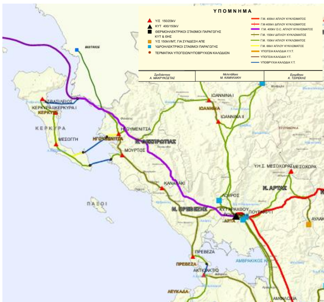
Figure 2-202: Greek Interconnected Electricity Transmission System (Source: Χάρτης Γραμμών Μεταφοράς | ΑΔΜΗΕ, June 2026)
